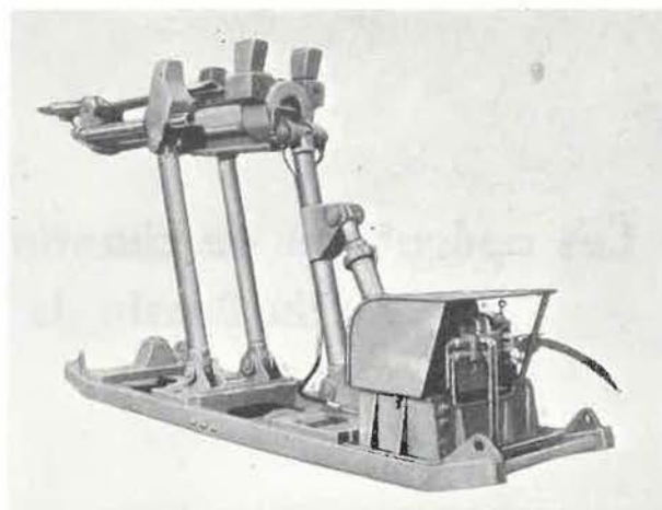
Fig. 88. — Machine Korfmann pour la reprise des cadres articulés.
