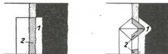
Fig. 12. — Schéma des coupes faites par un rabot ordinaire et un rabot à prisme.
