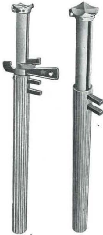
Fig. 51. — à droite : Étançon GHH pour dressant ; à gauche : Étançon GHH pour dressant avec extenseur GHH RS.
