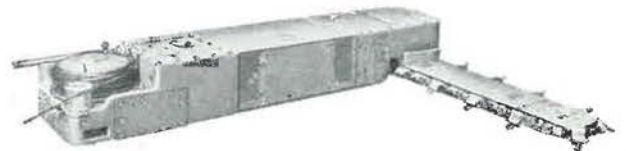
Fig. 20. — Haveuse Eickhoff SE III avec bras en position de havage.
