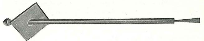
Fig. 25. — Boulon de toit.
