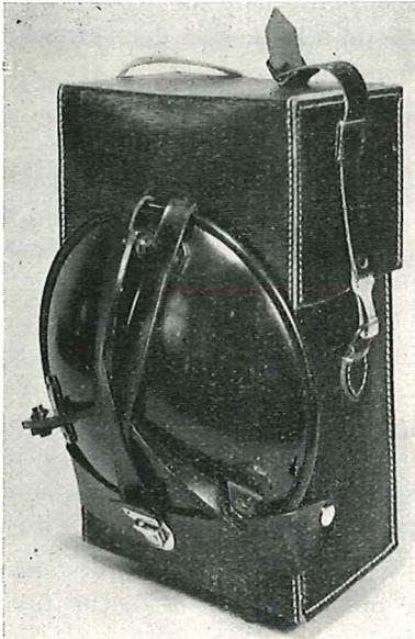
Fig. 59. — Microbaromètre Askania pendant le transport.
