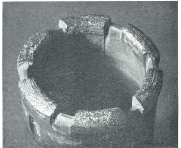
Fig. 5. — Couronne carottante à usure totale — Les pierres sont protégées par la cuirasse du liant métallique.
