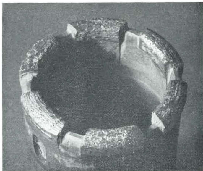
Fig. 5. — Couronne carottante à usure totale — Les pierres sont protégées par la cuirasse du liant métallique.
