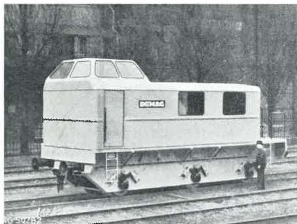
Fig. 30. — Treuil Demag monté sur wagon de chemin de fer avec cabine de protection.
