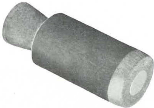
Fig. 18. — Élément de bourrage de mine préfabriqué.
