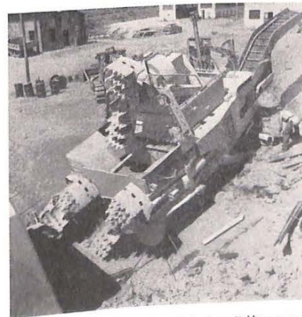
Fig. 1. — Machine de MM. Rodenbush et Robbins pour le creusement mécanique des galeries en roches.
