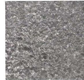
Fig. 6. — Coupe polie d'un coke au fer de Walsum à 50 % de fer après élimination du fer par HCl (gros. = 6).
