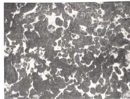
Fig. 5. — Coupe polie d'un coke au fer de Walsum à 50 % de fer (gros. = 25).
