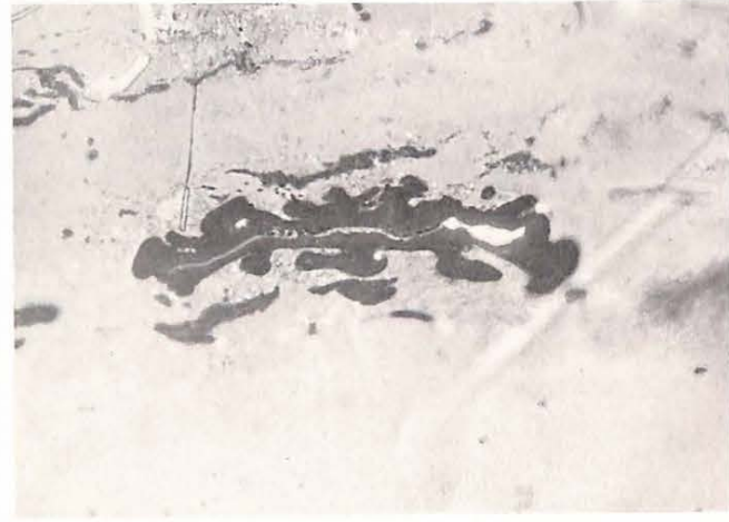
Figure 13. — Forme étonnante d'une coupe transversale de microspore. Veine Balduz, mine Brassart, surface polie, immersion en huile, 1.400 X (1500).
