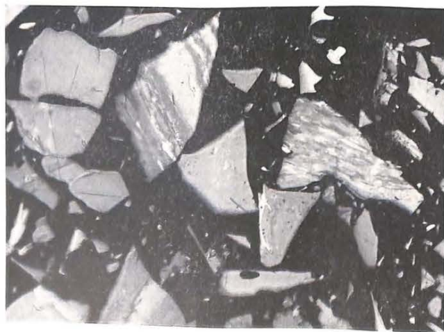
Figure 22. — Préparation en grains (n° 641) de charbon gras. Veine Hugo, immersion en huile, 350 X (718).
