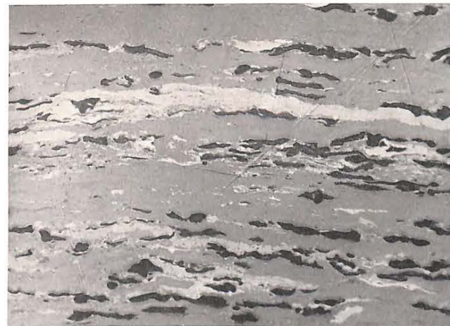
Figure 9. — Mélange vitrain-durain de charbon flambant : 24,4 % de durain 75,6 % de vitrain (Pas de clarain!)
