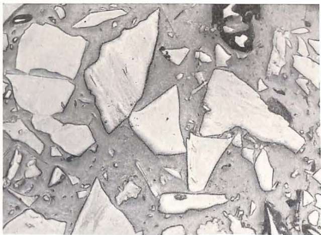
Figure 21. — Préparation en grains (n° 641) de charbon gras. Veine Hugo, à sec, 350 X (718).
