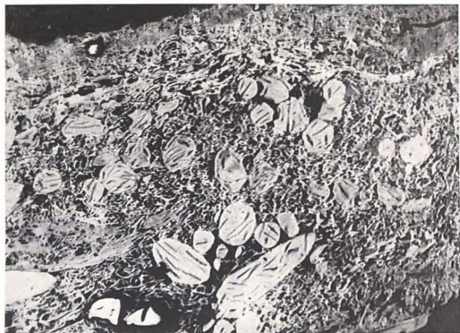
Figure 17. — Sclérotés à rainures de charbon flambant. Veine dite « Grenzkohlenflöz », Sarre, surface polie, immersion en huile, 300 × (861).
