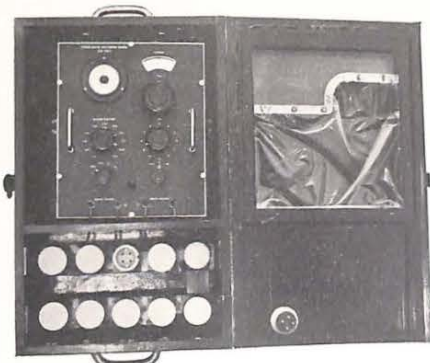
Fig. 3. — Pont de mesure et commutateur (le couvercle en matière plastique, à droite, est normalement rabattu sur l'appareil de mesure pour le protéger des poussières).
