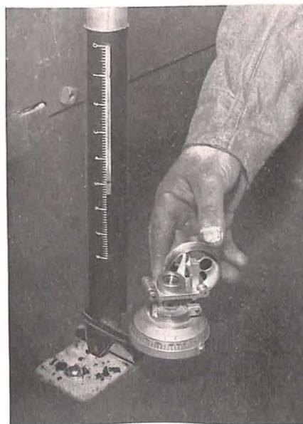
Fig. 23. — Le Romomètre (Roof Movement Meter).
