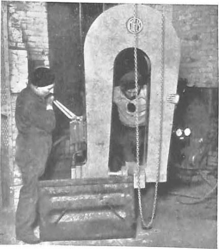
Fig. 8. — Presse pour caisses de berlines.
