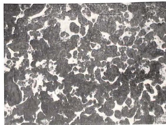
Fig. 5. — Coupe polie d'un coke au fer de Walsum à 50 % de fer (gros. = 25).
