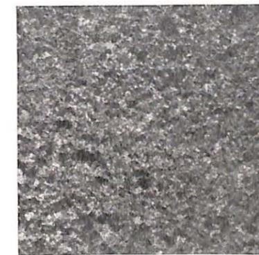
Fig. 6. — Coupe polie d'un coke au fer de Walsum à 50 % de fer après élimination du fer par HCl (gros. = 6).
