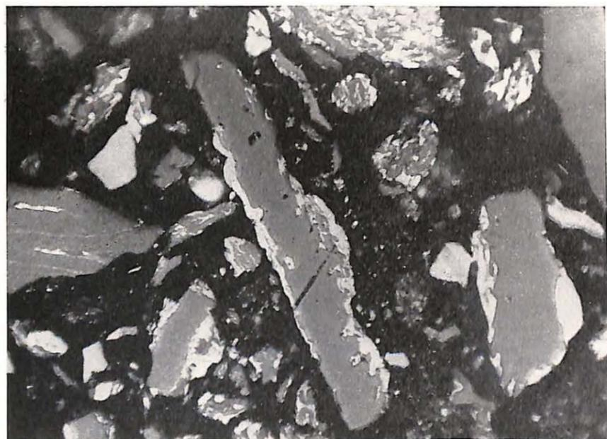
Figure 25. — Concentré de durain de charbon flambant, obtenu par broyage dans un désintégrateur à marteaux. Caticules. Préparation en grains, immersion en huile, 350 X.
