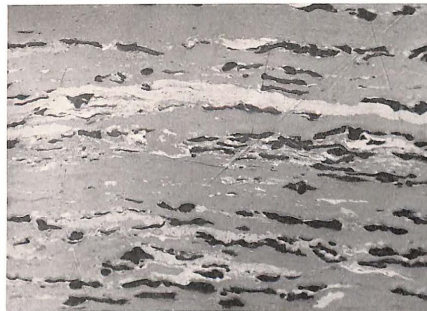
Figure 9. — Mélange vitrain-durain de charbon flambant : 24,4 % de durain
