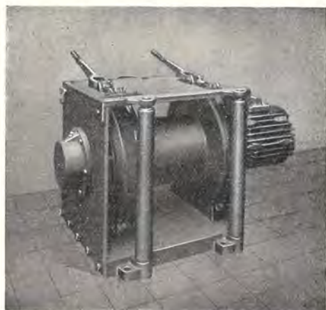
Treuil électrique à embrayage progressif, moteur antigrisouteux incorporé.
