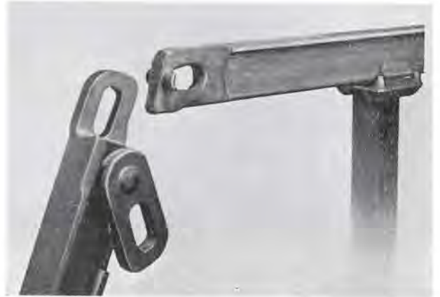
Fig. 19. — Bèle Gerlach, modèle 1950 avec joue mobile.
