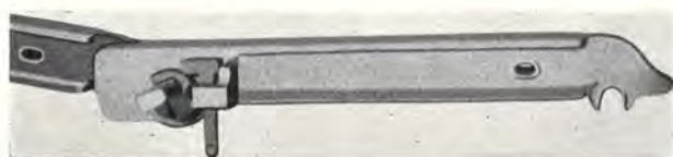
Fig. 16. — Reprise de la bèle Jadot. La cale a été levée et la rotation de la clavette s'opère sous la charge.
