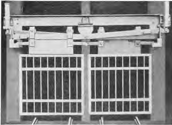
Fig. 16. — Dispositif de fermeture automatique des barrières des puits et des burquins.
