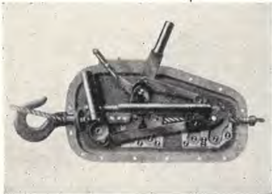
Fig. 26. — L'engin de traction et de levage Tirfor.
