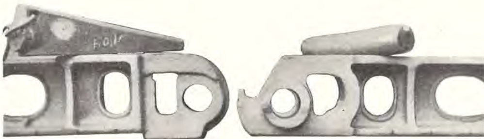
Fig. 11. — Vue des deux extrémités de la bèle « Belgam » (type 2).
