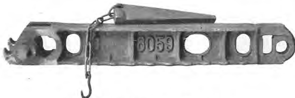
Fig. 10. — Bèle « Belgam » en acier moulé (type 2).
