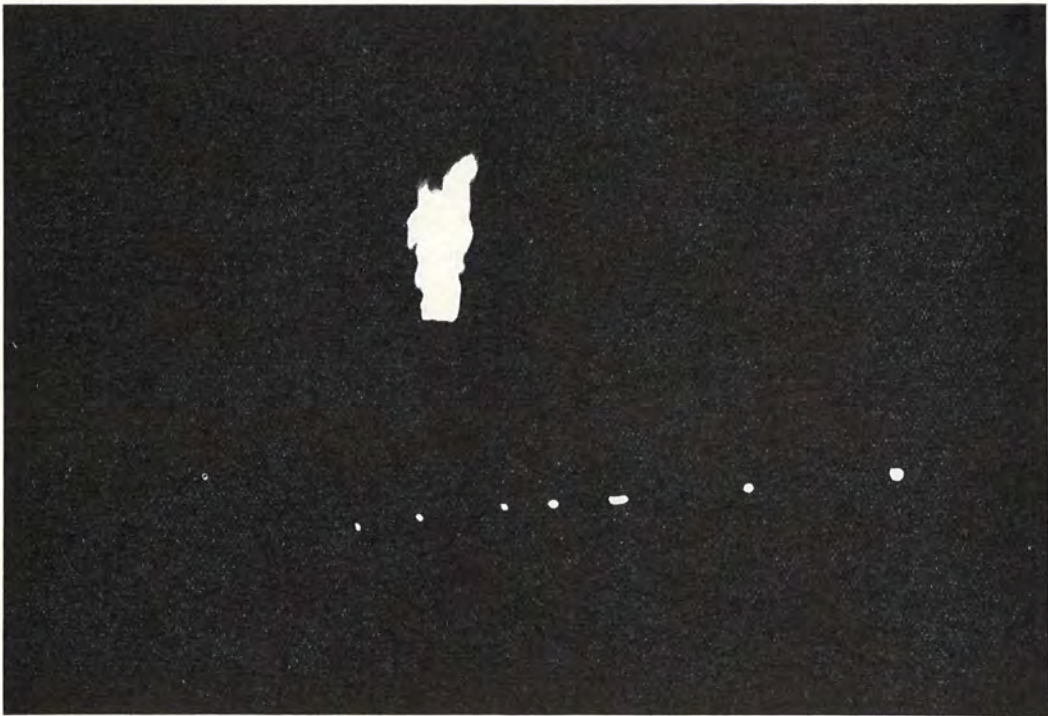
Fig. 13. — Essai en maquette : gaz brûlant à la cheminée et aux prises d'échantillons.
