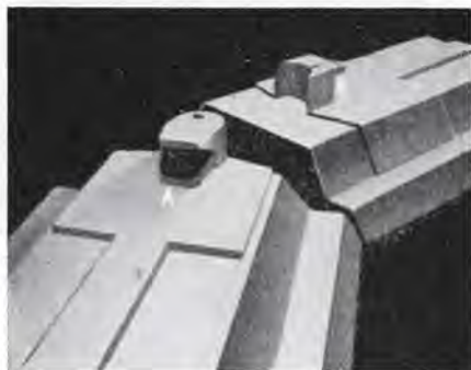
Fig. 10. — Attaches axiales A et B fixées sous les couloirs (système Jadot).
