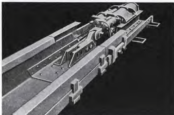
Fig. 12. — Couloir oscillant blindé ripable. Porte et Gardin avec moteur en tête de l'installation.
