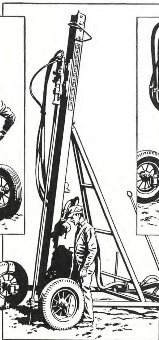
Pour la forage de roches dures, choisissez Gardner Denver WD, le type spécialement conçu pour des forages profonds. Il possède un puissant pouvoir de nettoyage des fourneaux forés. Il peut travailler par fosses de 3 ou de 4,5 m.
