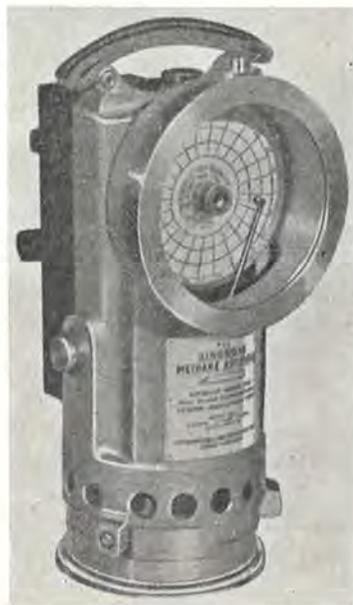
Fig. 7. — Enregistreur automatique de méthane « Ringrose ».
