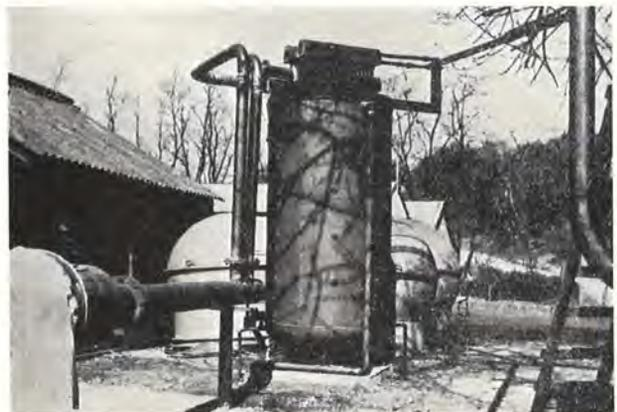
Fig. 7. — Evaporateur d'oxygène.
