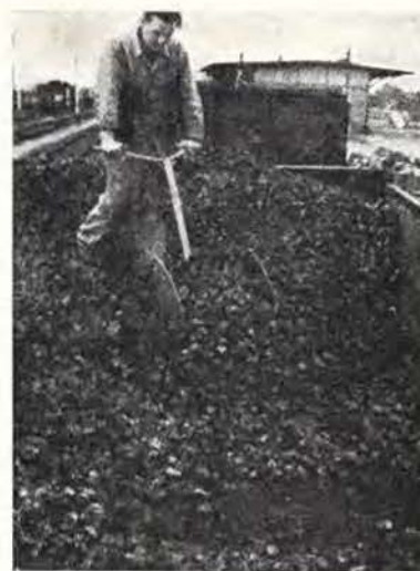
Fig. 18. — Pelle pour le déchargement d'un wagon.
