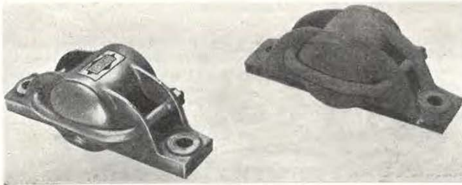
Fig. 24. — Pièce nettoyée par le procédé « Derustit ». — Après et avant traitement.
