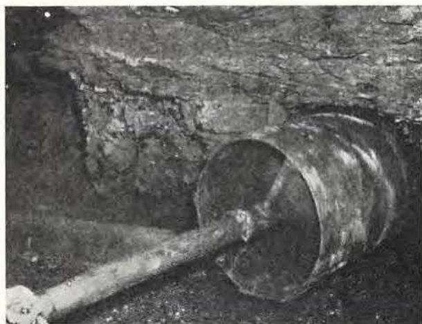
Fig. 2. — Tête de forage en service, montée sur l'arbre de commande et le châssis spécial qui facilitent le placement de la tête à l'endroit voulu.
