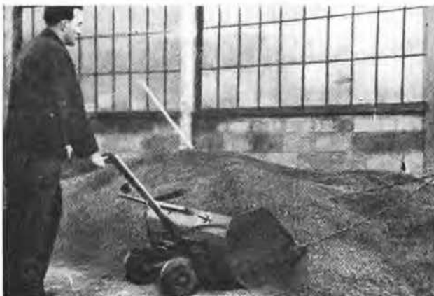
Fig. 19. — Pelle ramasseuse avec châssis roulant pour ramassage et pelletage au sol.
