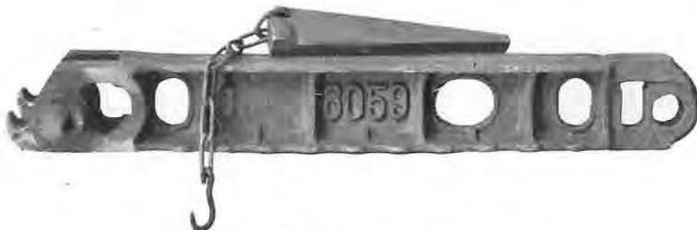
Fig. 10. — Bèle « Belgam » en acier moulé (type 2).
