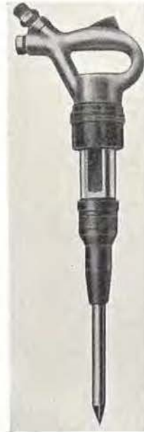
Fig. 2. — Marteau piqueur «Lacroix» avec poignée en alliage léger.
