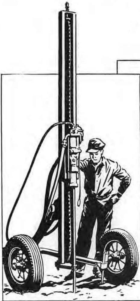
Le type léger Gardner Denver LCM. est idéal pour tous les travaux qui exigent de fréquents déplacements. Equipé pour travailler par fosses de 1,80 m. il est parfaitement maniable.
