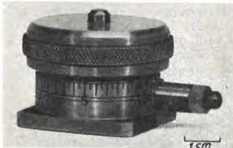
Fig. 5. — Vue de l'indicateur au quartz placé sur la poignée.
