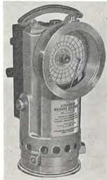
Fig. 7. — Enregistreur automatique de méthane « Ringrose ».
