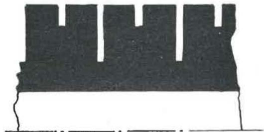
Fig. 4. — Rouleau caoutchouté à rainures multiples (Chain Belt).
