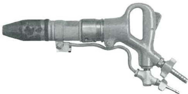
Figure 12bis. — Photographie du marteau-piqueur à pulvérisateur sans graisseur.
