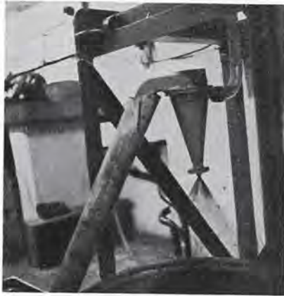
Fig. 4 et 5. — Ecoulement normal et écoulement d'un cyclone surchargé.
