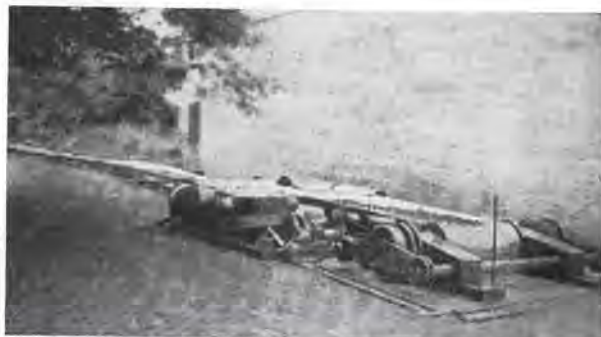
Fig. 10. — Le moteur du convoyeur développable du B.C.R. de Huntington.
