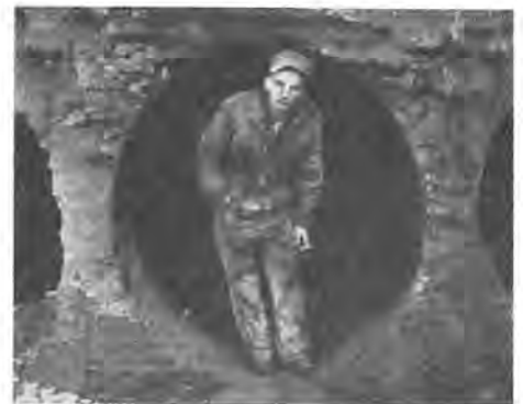
Fig. 8 et 8bis. — Exploitation de la couche Pittsburg par tarudage.
