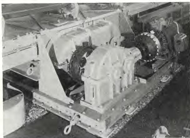
Fig. 5. — Tête motrice de 60 CV. - Accouplement hydraulique et dispositif de frein à rochet.
