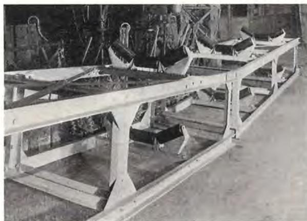
Fig. 8. — Convoyeur à 2 brins porteurs.
