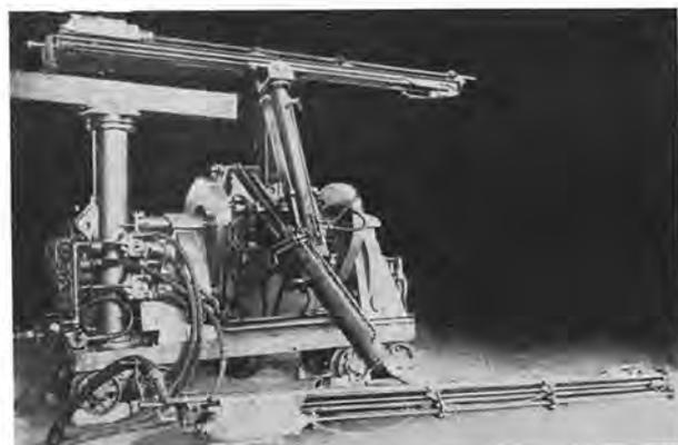
Fig. 101. — Chariot de forage Hausherr et Söhne.
