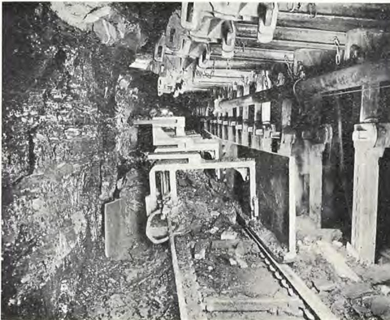
Fig. 67. — Le rabot « Radbod » sur convoyeur blindé.
