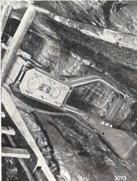
Fig. 76. — Haveuse à cadre Soest Ferrum pour couches à fort pendage.
