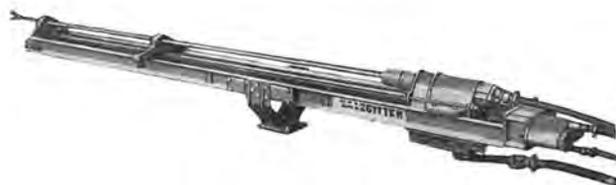
Fig. 102. — Foreuse rotative et vibrante Salzgitter.
