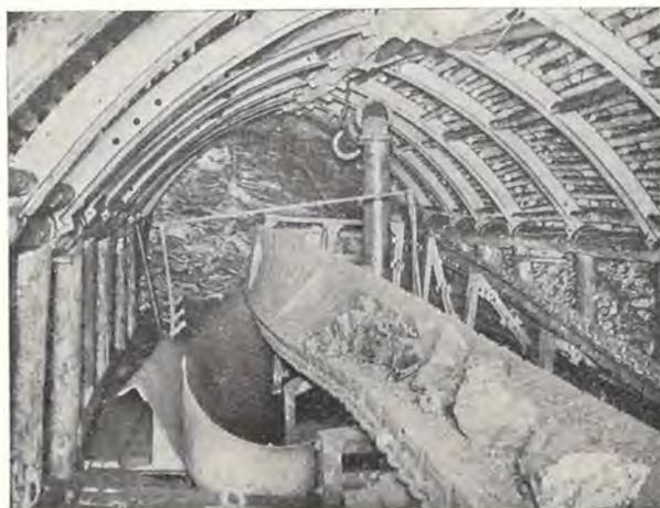
Fig. 54. — Enroulement en hélice autour de l'axe longitudinal du transporteur et retournement dans le plan perpendiculaire au transporteur (Friedrich der Grosse (Ruhr)).
