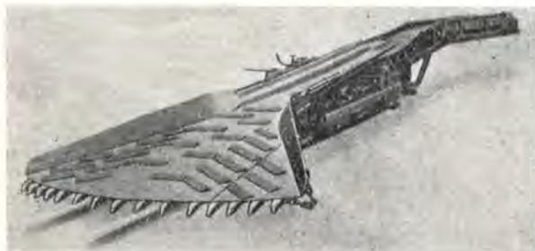
Fig. 105. — Pelle mécanique Bergtechnik à Lünen (modèle réduit).
