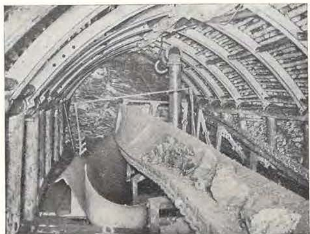
Fig. 54. — Enroulement en hélice autour de l'axe longitudinal du transporteur et retournement dans le plan perpendiculaire au transporteur (Friedrich der Grosse (Ruhr)).
