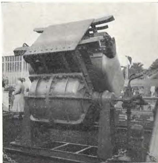
Fig. 87. — Culbuteur à segment Mönninghoff. Position de la berline en fin de course.
