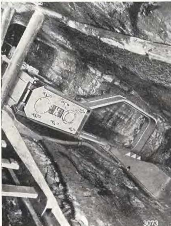
Fig. 76. — Hauceuse à cadre Soest Ferrum pour couches à fort pendage.
