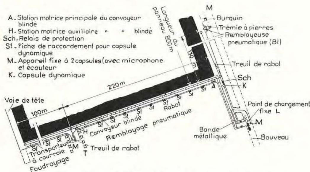
Fig. 6. — Représentation simplifiée de l'installation téléphonique avec capsules dynamiques, Couches Dickebank. — Charbonnage de Westerholt.
