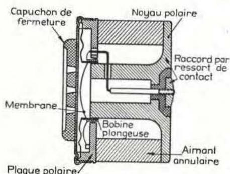
Fig. 1. — Section transversale d'une capsule dynamique.
