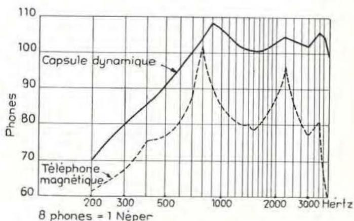
Fig. 2. — Courbes de fréquence du téléphone magnétique et de la capsule dynamique.
