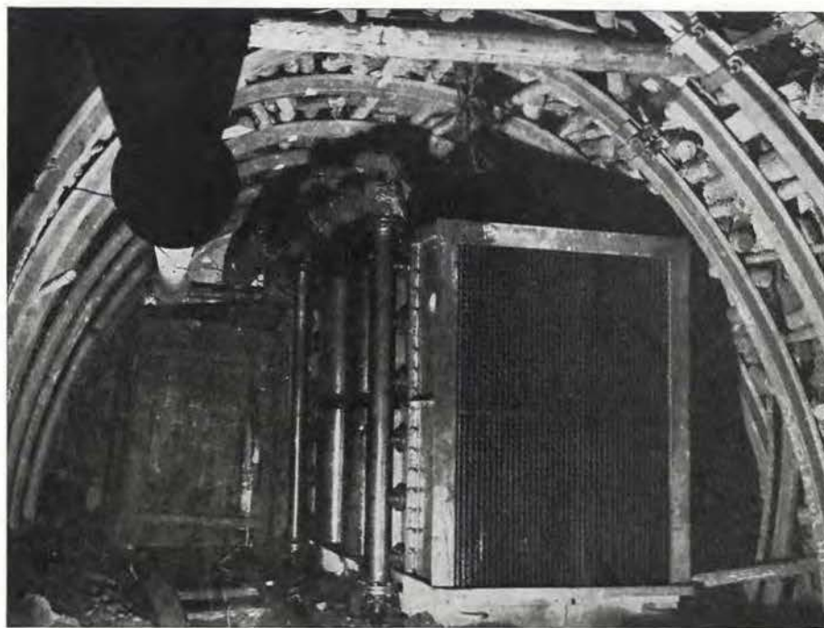
Fig. 9. — Installation de réfrigération souterraine du Charbonnage des Liégeois — Echangeur.
