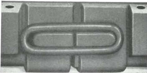
Fig. 13. — Convoyeur blindé « Beien »; maillon d'assemblage des couloirs.
