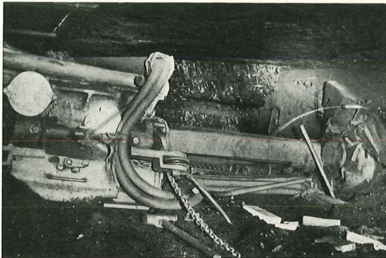
Fig. 7. — Machine du type surbaissé dans une taille de 1,05 m d'ouverture avec mur soufflant.
