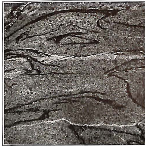
Fig. 29. — Faux mur (Underlay) présentant des traces de surfaces de décollement. (lumière naturelle; \times 30 )
