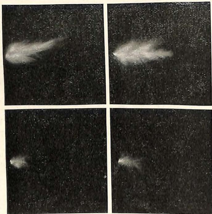
Fig. 6. — Flammes d'un coup de 4 cartouches de Détonit B tiré au rocher.
