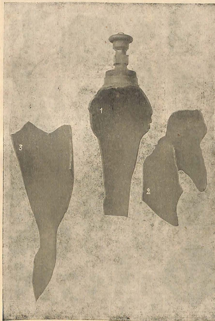
Débris de la bouteille à acide carbonique qui a fait explosion.
