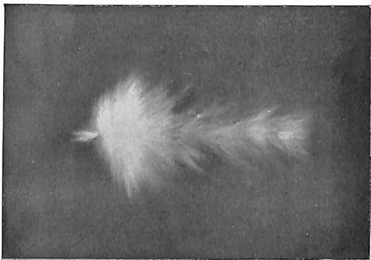
Phot. 3. — Matagnite R. 500 grammes. — 5 cartouches de 30 m/m amorcées par une cartouche de Dynamite n° 1 — Détonateur à gauche. Objectif à 3 mètres de la charge.
