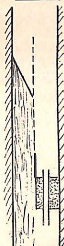
Confection d'une plate-cuve. Constitution d'un réservoir dans la partie est du puits.
