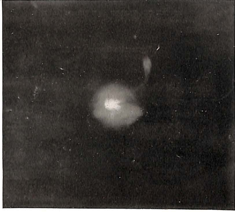
Phot. 48. — Dynamite gomme n° 1. 100 grammes. — 1 cartouche. — Section de 2 mètres carrés.
