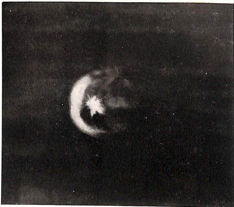
Phot. 46. — Explosif E. 400 grammes. — 4 cartouches 3 + 1. — Section de 2 mètres carrés.
