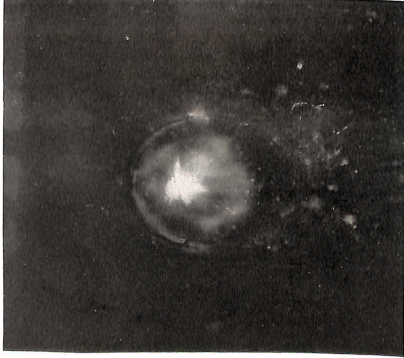
Phot. 49. — Dynamite gomme n° 1. 300 grammes. — 3 cartouches en 3 files. — Section de 2 mètres carrés.
