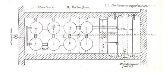
notamment de deux tubes indicateurs de niveau d'eau portés par un avant-corps du premier bouilleur transversal.
