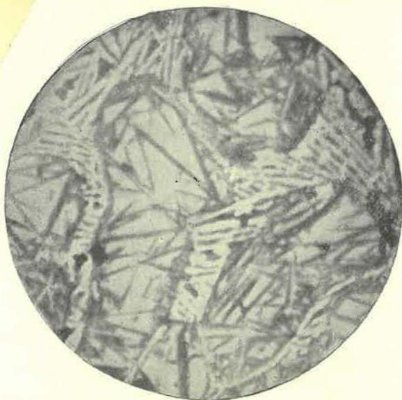
FIG. 5. — Cuivre 7.64 0/0; fer 89.0 0/0; carbone 2.30 0/0; silicium 0.84 0/0.
