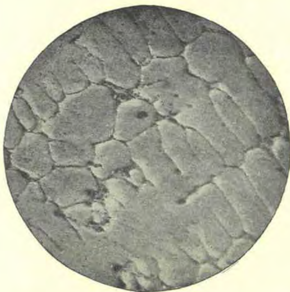
FIG. 3. — Cuivre 20.5 0/0; fer 79.1 0/0. — Structure développée par polissage. — Parties blanches : Constituant fer-cuivre. — Parties noires : Constituant cuivre-fer.
