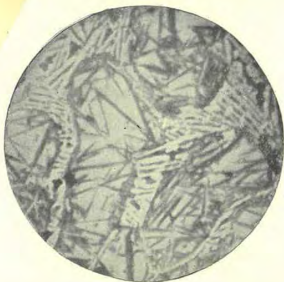
FIG. 5. — Cuivre 7.64 %; fer 89.0 %; carbone 2.30 %; silicium 0.84 %. — Attaque par l'iode. — Enveloppe en réseau : Cémentite. — Parties foncées en zig-zag : Structure de la martensite. — Fond blanc : apparement de l'austénite.
