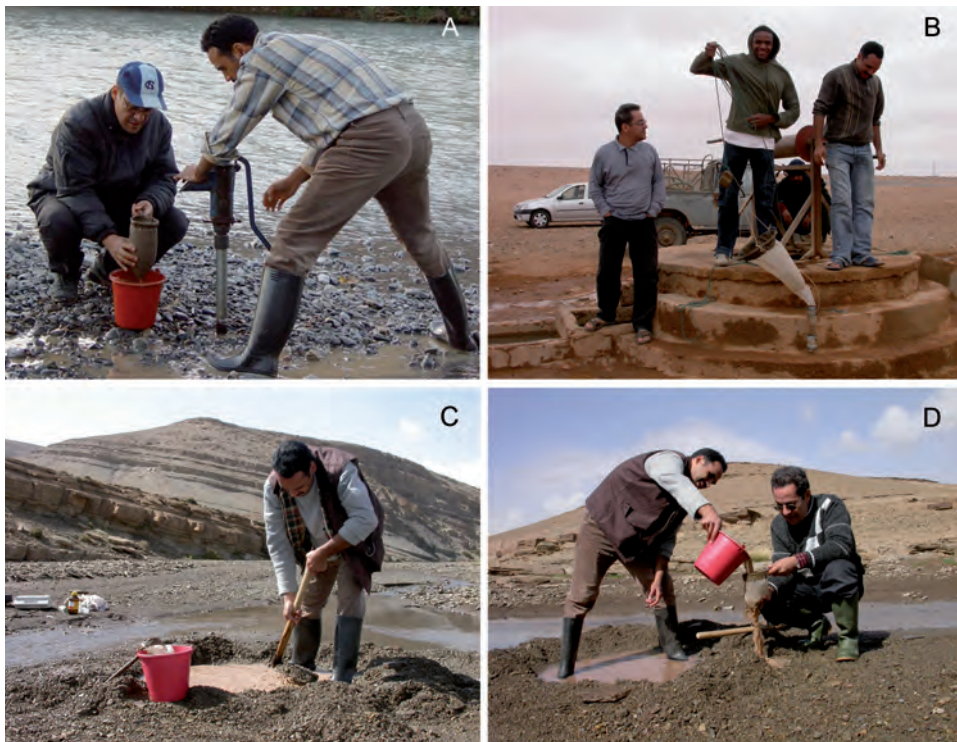
Fig. 8. A-D. Aperçu des moyens d'échantillonnage des eaux souterraines. A. Pompe Bou-Rouch. B. Filet Cvetkov (puits). C-D. Méthode de Karaman-Chappuis.
