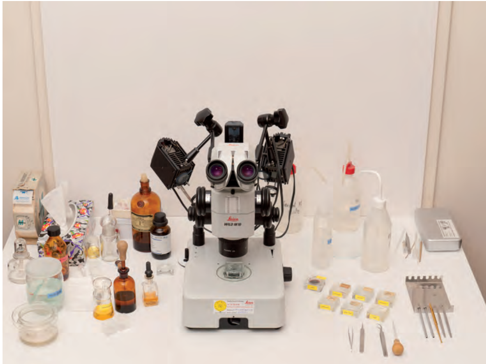
Fig. 9. Vue d'ensemble du matériel nécessaire aux préparations d'oligochètes. En avant-plan, de la gauche vers la droite : lames placées dans de l'alcool dénaturé légèrement acide, milieux de montage (baume de Canada, glycérine, polyvinyl lactophénol), lamelles couvre-objet de deux tailles différentes, loupe binoculaire, ensemble de salières disposées pour le montage avec la méthode du paracarmin, pinces diverses (pince fine et brucelles), aiguilles fines et micro-scalpels (Photo : Th. Hubin).
