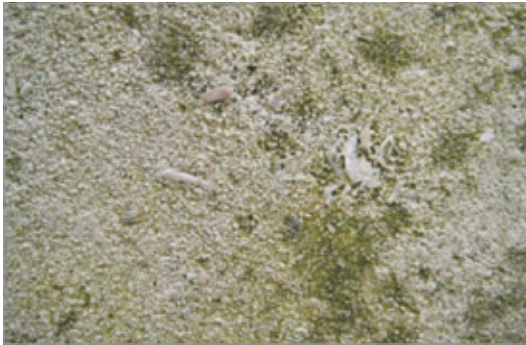
Afbeelding 37 Met groene algen gekoloniseerd verweerd oppervlak (grafsteen) van Portlandsteen: in de grondmassa van kleine kalkbolletjes (ooiden) zijn grotere fossielfragmenten (schelpen) goed herkenbaar.
