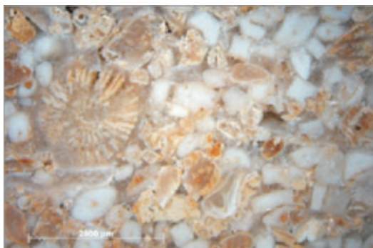
Afbeelding 6 Senonvillesteen onder de loep: behalve crinoïden herkennen we ook ander grote bioklasten zoals kalksponzen en koraaltjes.
