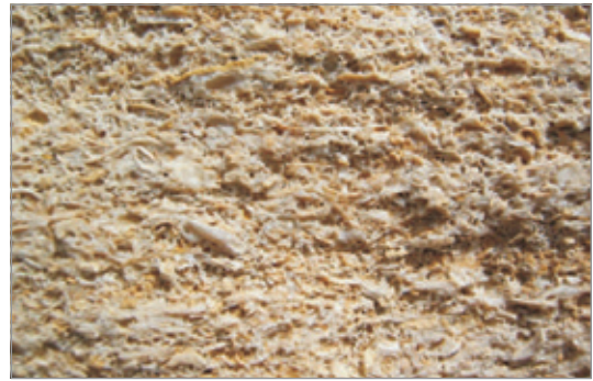
Afbeelding 12 Macroscopische opname van een vers breukvlak in Savonnièressteen: dichte stapeling van kalkbolletjes en schelpen in wisselende verhoudingen en intensiteiten van cementatie.
