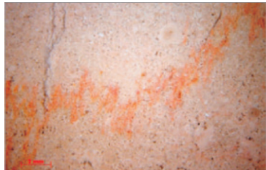
Afbeelding 29 Gepolijst oppervlak van Rocherons onder de loep: stapeling van ooiden, kleine bioklasten en oncoïden, met karakteristieke grillige rode stylolieten.
