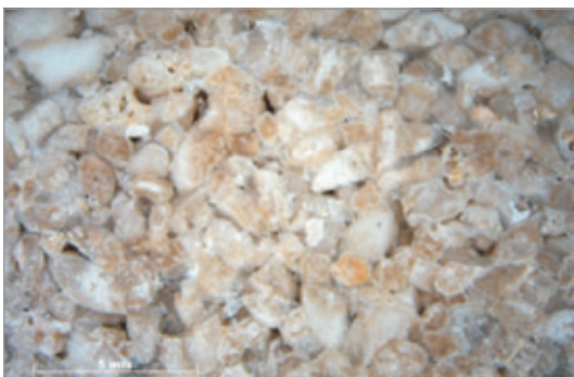
Afbeelding 5 Euvillesteen onder de loep: wit calcietcement omhult de ovale doorsneden van de crinoïdenstengelleden.
