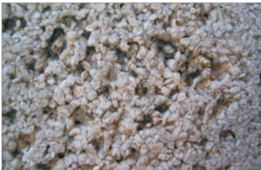
Afbeelding 3 Macroscopisch detail van meteorisch verweerde Euvillesteen: kristalvlakken van calciet zijn duidelijk herkenbaar in de stengelleden. Afbrokkeling door vorstschade.
