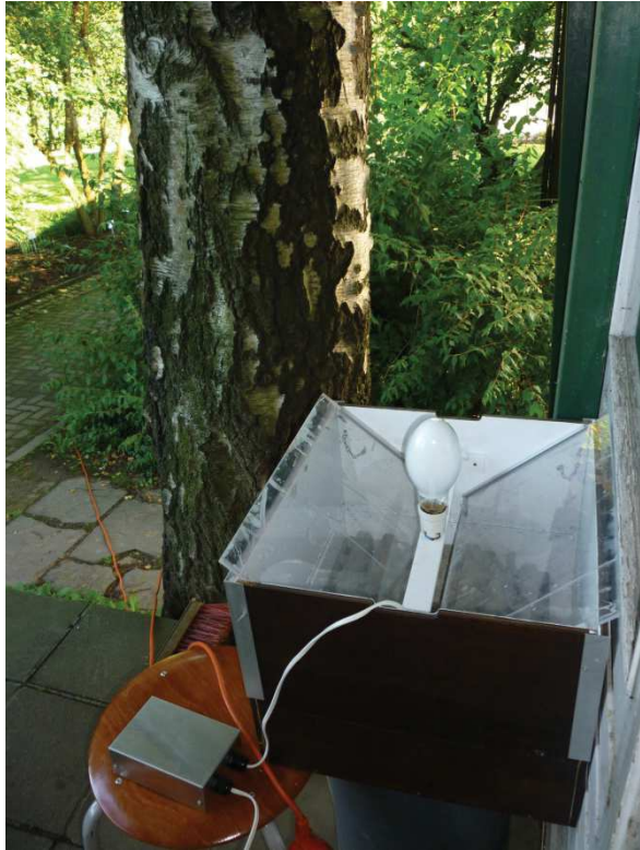
Fig. 1. De gebruikte automatische UV-lichtval in de Botanische Tuin Jean Massart te Oudergem (Brussels Hoofdstedelijk Gewest) (Foto : Alain Drumont).
