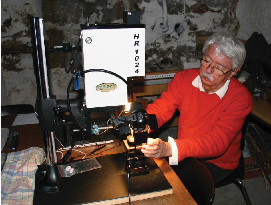
Fig. 7 – L’auteur et le spectroradiomètre dans le conservatoire de l’Institut d’Archéologie de Fribourg en 2014. Notez l’utilisation d’une fibre optique dont l’utilisation constitue un progrès important. Photo : P. Pétrequin.
