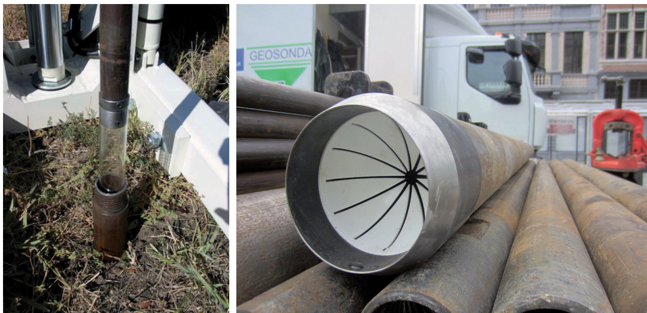
Fig. 2 – Geoprobe steekboring met liner (links) en core catcher (rechts).
