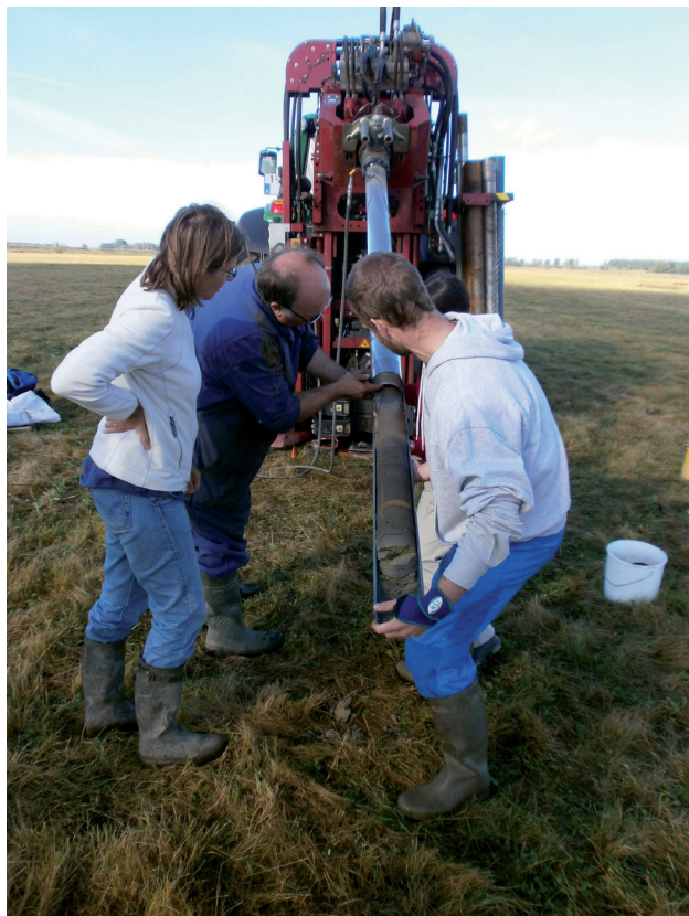
Fig. 4 – Het Sonic Drill Aqualock boormonster kan zonder liner uitgeduwd en ter plekke bestudeerd worden.
