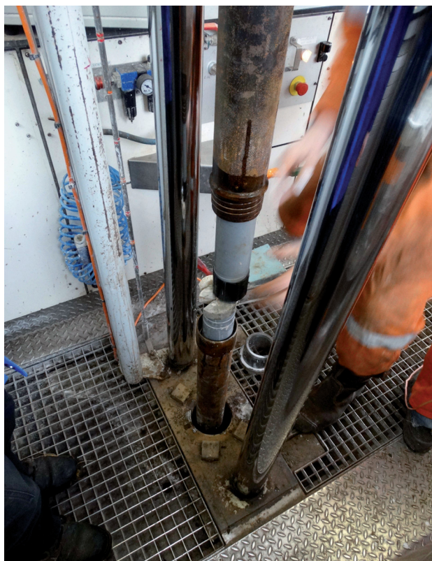
Fig. 6 – Recuperatie en doorsnijden van het Begemann staal.
