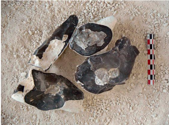
Fig. 10 – Exemples d'inclusions crayeuses et de structures incomplètement silicifiées présentes dans les blocs de la ST 20. En haut, à gauche inclusion crayeuse.
