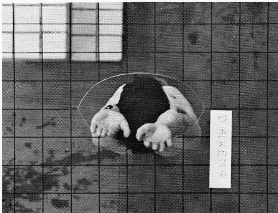
FIG. 8. — Projectie van het grootspantoppervlak of grootste dwarse lichaamsoppervlakte.
