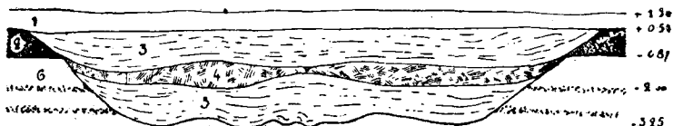
Coupe géologique montrant les dépôts fluviatiles dans le polder de Steenborgerweert à Anvers. (L'échelle des hauteurs est vingt fois plus grande que celle des longueurs).
