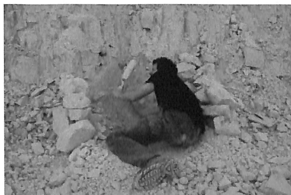
Fig. 11 — Expérimentation 2. En travaillant couché sur le flanc, le mineur peut manier son pic à deux mains et investir au minimum l'espace disponible (photo M. Woodbury).
