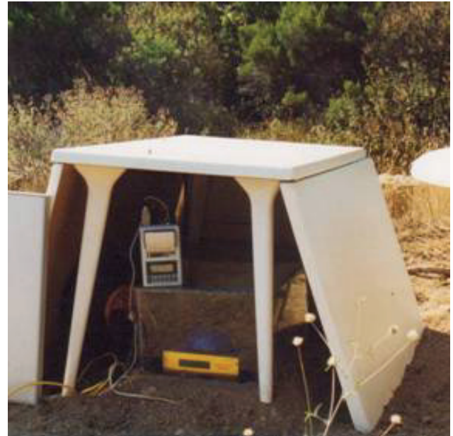
Figure 3.3. Installation de mesure de l'exhalation par le sol (à l'abri du rayonnement solaire direct).
