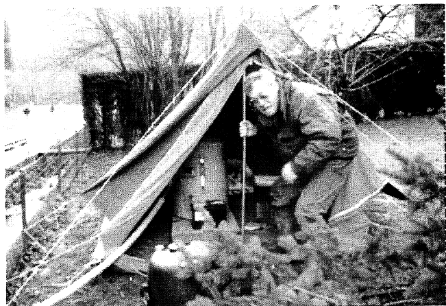
Figure 8 : Prélèvement d'eau à la Résurgence du Tahaux à l'aide d'un échantillonneur automatique permettant des prises d'eau régulières et sur une longue période.
